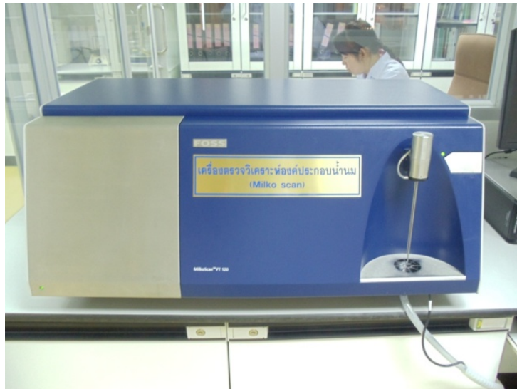
รูปภาพที่ 17 เครื่อง Milko scan ตรวจสอบเนื้อมันทั้งหมด (TS) และเนื้อมันไม่รวมมันเนย (SNF)
